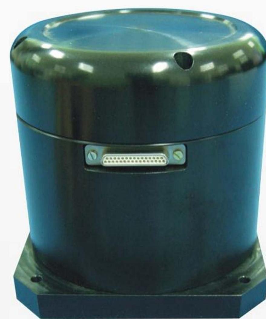
战术级光纤捷联惯组由惯性敏感组件、相关电子线路和机箱组成，具有角速率和加速度输入输出、误差自补偿等功能，可为飞行控制系统、稳定控制系统提供所需的角速度、加速度测量值，适用于短距导弹、小型无人机、天线稳定基准、火箭弹制导化改造等应用领域。
